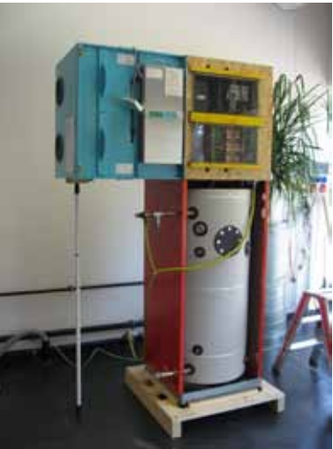
Slika 30: Razstavni model kompaktne enote za ogrevanje in prezračevanje.
