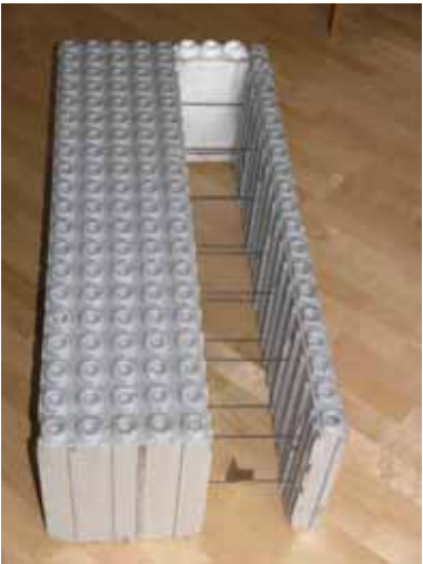
Slika 8: Zidaki iz polistirena so široki 100 cm, v vmesno odprtino se namesti armaturo in zalije z betonom (na sliki v primerjavi z velikostjo prenosnega telefona).
